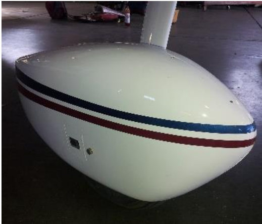
Obr. 5: Aerodynamický kryt Cessna 185 (N3946Q) z vnější strany [6]
