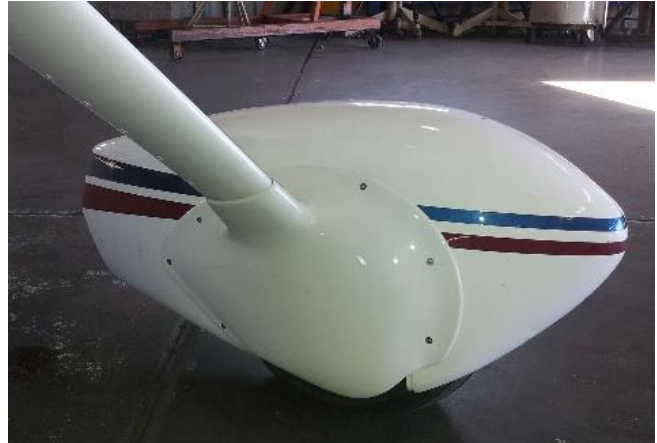
Obr. 6: Aerodynamický kryt Cessna 185 (N3946Q) z vnitřní strany [6]
