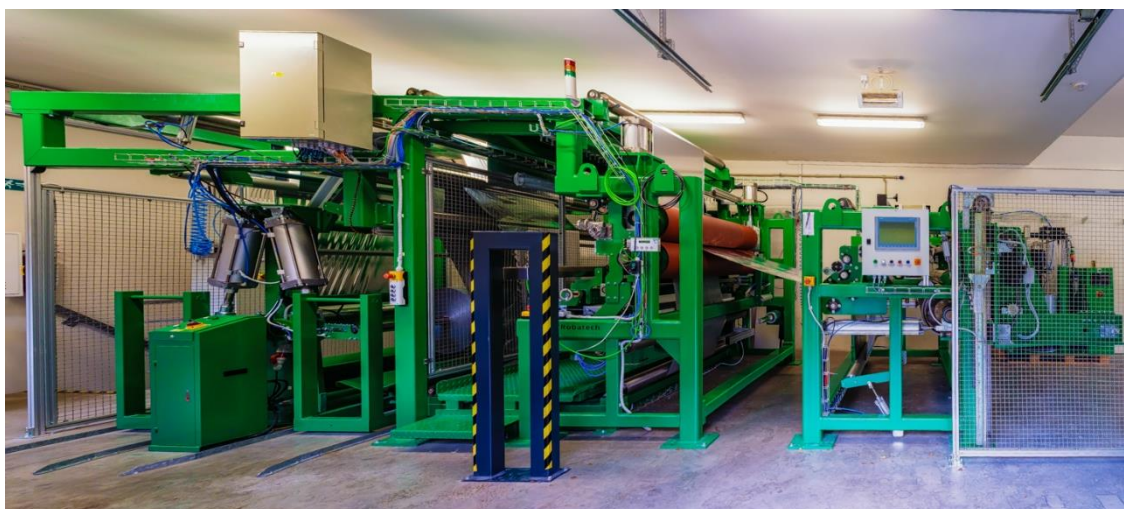
Obrázek 6: Laminační linka (zdroj: vlastní fotografie)
