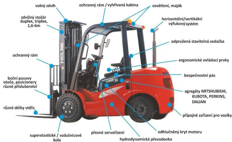
Obr. 23- Části VZV, Vozík HELI 1-3,5t; Zdroj: vysokozdvizny-vozik.cz
