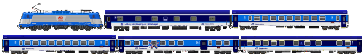
Obrázek 28 - Souprava Ex7 (Jižní Expres) s lůžkovým vozem - 380 + WLABmz + 2x Bdpee + Bbdgmee + Armpee
