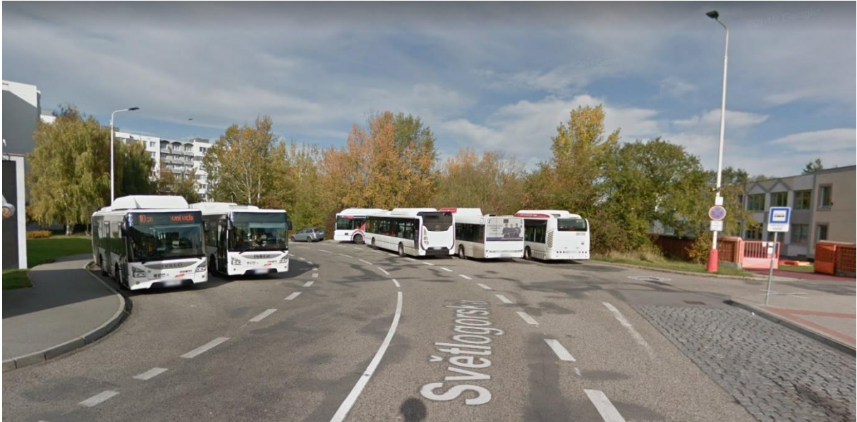
Obr. 21: Ukázka sníženého rozhledu v případě odstavených autobusů (zdroj: maps.google.com)
