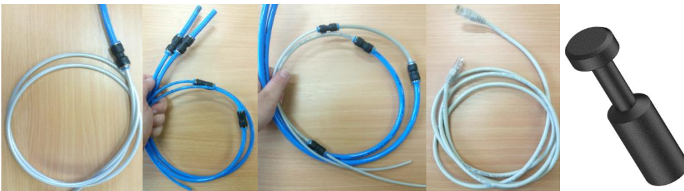
Obr. 48 Zleva: hadice a nástrčná redukovaná spojka pro napájení FMT, hadice a nástrčné redukované spojky pro jeden aktuátor, hadice a nástrčné redukované spojky pro druhý aktuátor, ethernetový kabel, záslepka [65]
