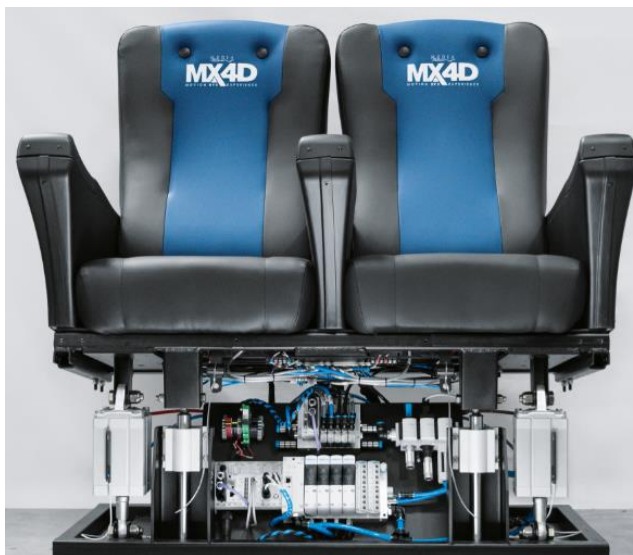
Obr. 30 Sedačka MX4D Motion EFX pro 4D kina s odhalenou spodní konstrukcí [41]
