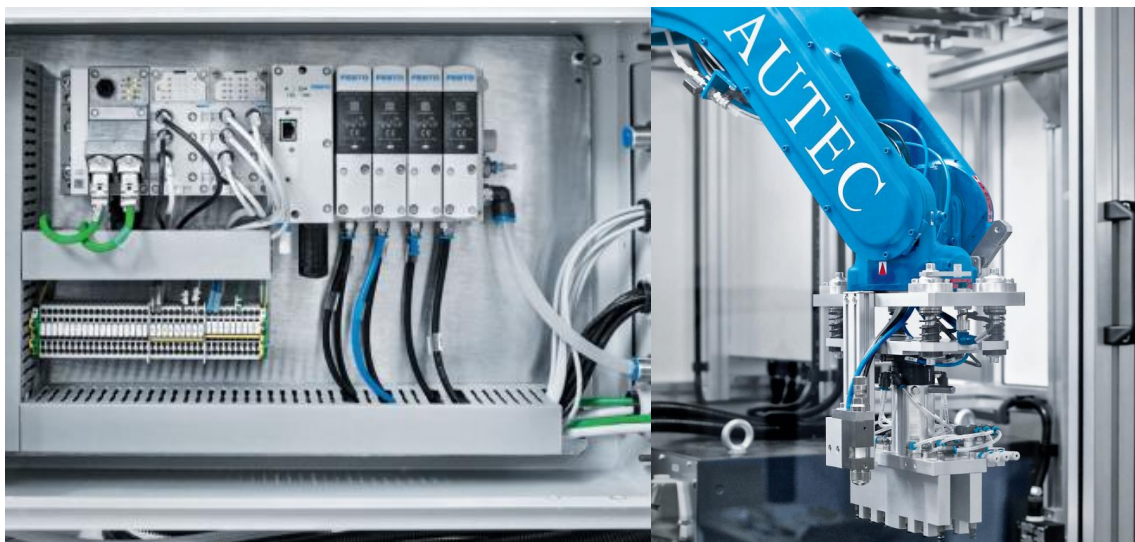
Obr. 31 Vlevo: zapojení FMT v přístroji, vpravo: hlava stroje na lepení [42]
