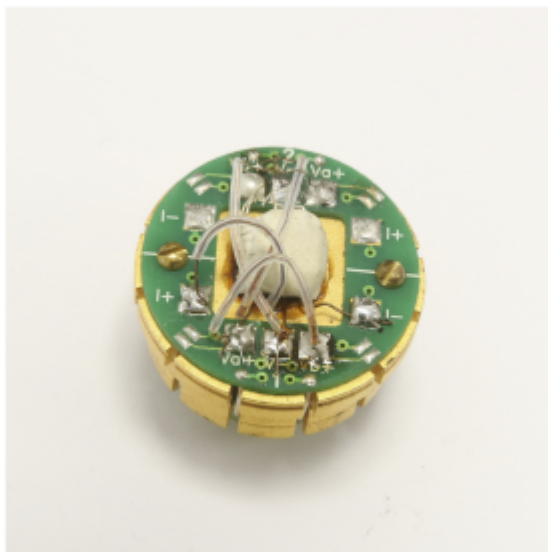
Obr. 17: Hallova sonda používaná pro měření Hallova napětí. Dostupné z [19].
