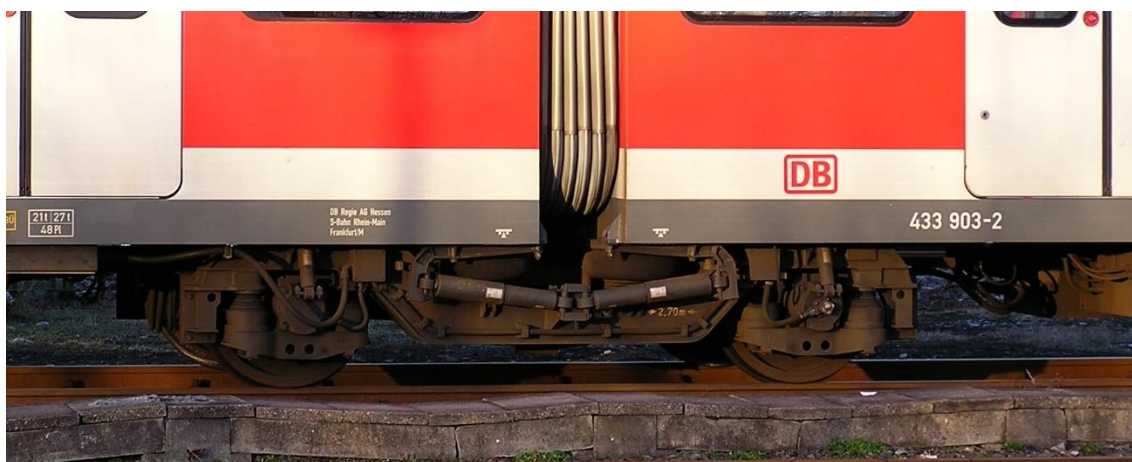
Obr. 1-3 – „Nepravý“ Jacobsův podvozek elektrické jednotky DB 423 a 433 [4]
