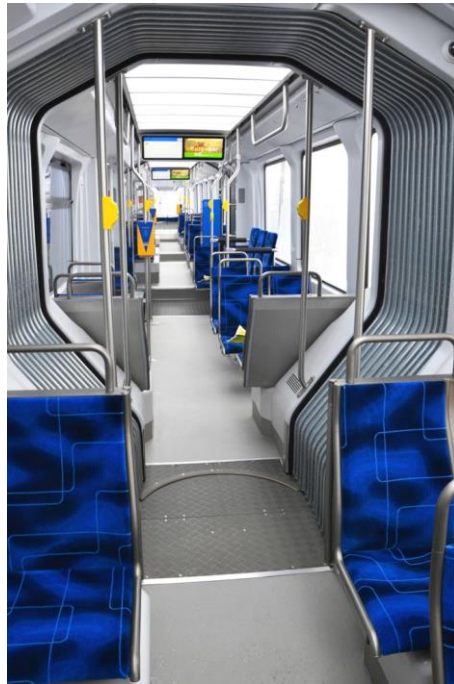
Obr. 2-21 – Interiér tramvaje Solaris Tramino XL, měch nad Jacobsovým podvozkem [30]
