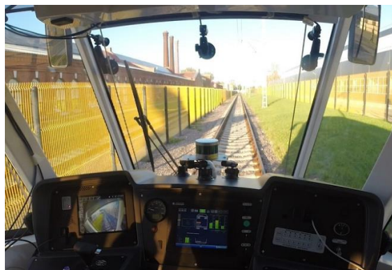
Obrázek 44. Kabina řidiče vybavená lidarem a kamerami. [22]
