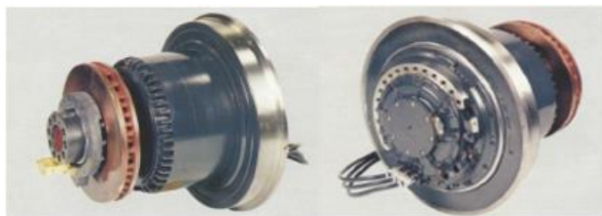
Obrázek 67. Neodpružený pohon s kolovým motorem.[7]
