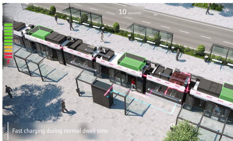
Obrázek 50. Vizualizace napájení baterií během stání tramvaje v zastávce. [25]
