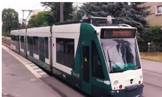
Obrázek 41. Tramvaj vybavená senzory pro autonomní řízení v reálném provozu. [21]
