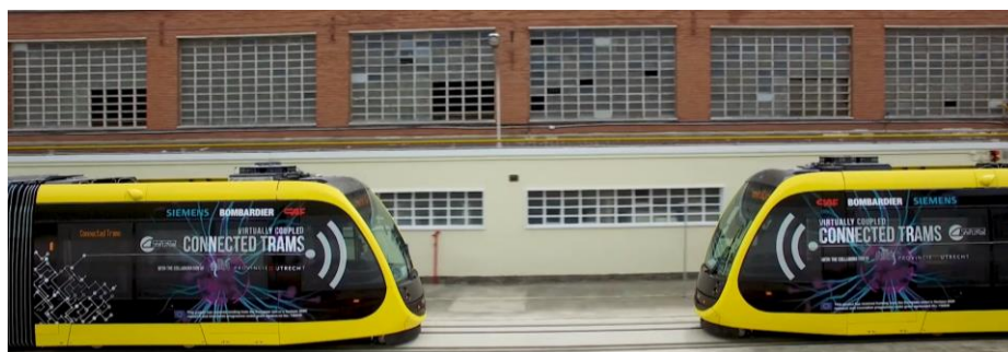
Obrázek 73. Spřažené tramvaje Urbos 3 společnosti CAF při testování virtuálního spřáhla. [32]
