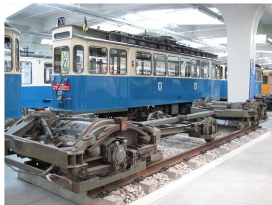
Obrázek 16. Pojezd tramvaje L. [8]
