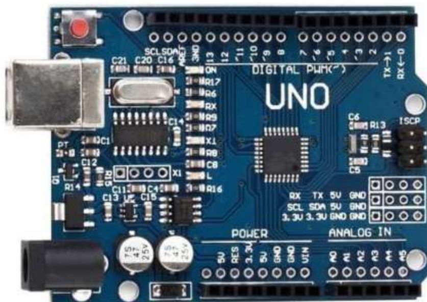
Obrázek 37: ARDUINO UNO R3 [13]
