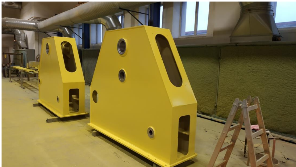
Obrázek 121.: Nalakované boční stojany manipulátoru
