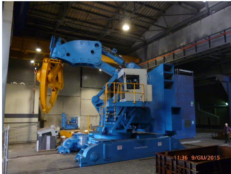
Obrázek 8.: 20t manipulátor s uchopovacím ramenem [8]
