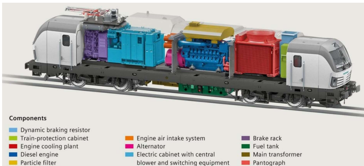
Obrázek 16 - Rozložení strojovny lokomotivy Vectron Dual Mode [25]
