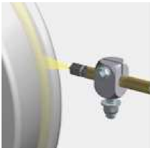
Obrázek 47 - Možné řešení mazání okolků [45]
