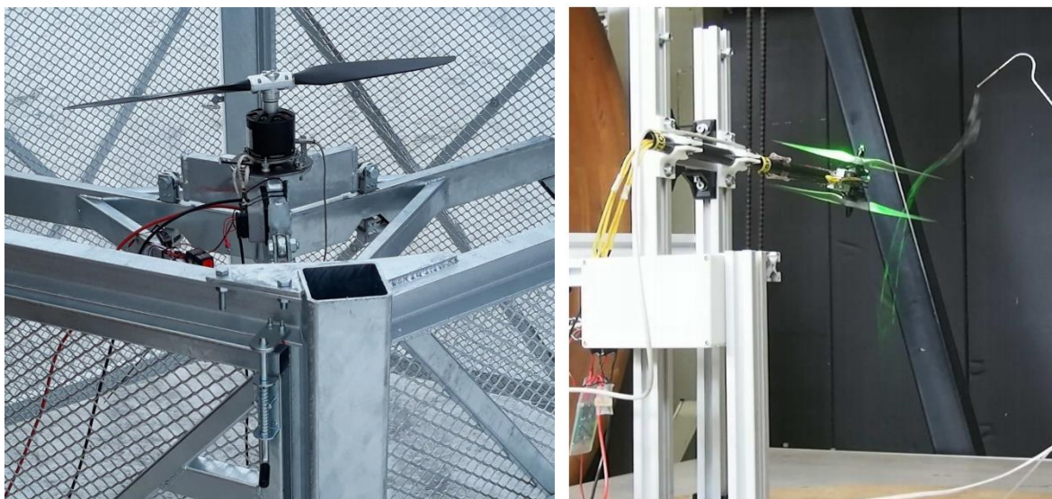
Obrázek 20: Vlevo: Stand na statická měření jednoduché vrtule [21], Vpravo: Statické měření protiběžných vrtulí včetně vizualizace proudění [22]
