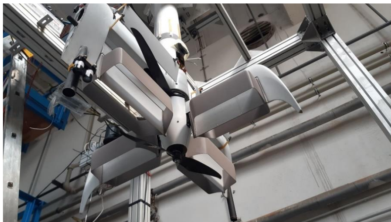
Obrázek 62: Rozšíření standu o měření síly vyvolané kormidlem, detail měřených úprav kormidel
