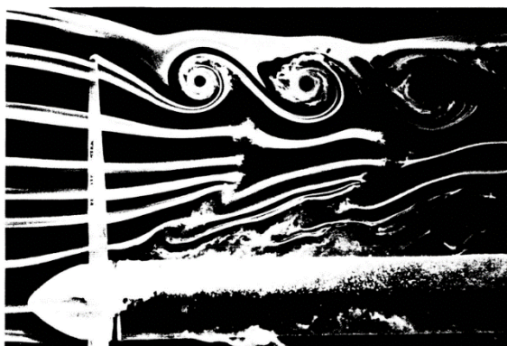
Obrázek 18: Vizualizace obtékání dvoulisté vrtule [19]
