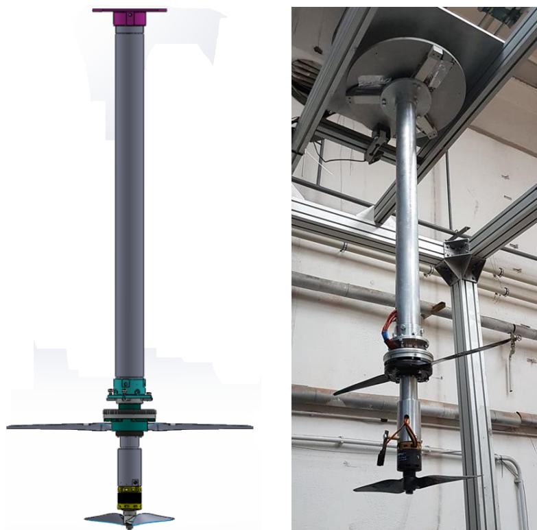
Obrázek 31: Vlevo: model tělesa nesoucího motory. Vpravo: těleso s motory a vrtulemi připravené k měření
