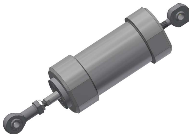
Obr. 22 – 3D model pružícího prvku
