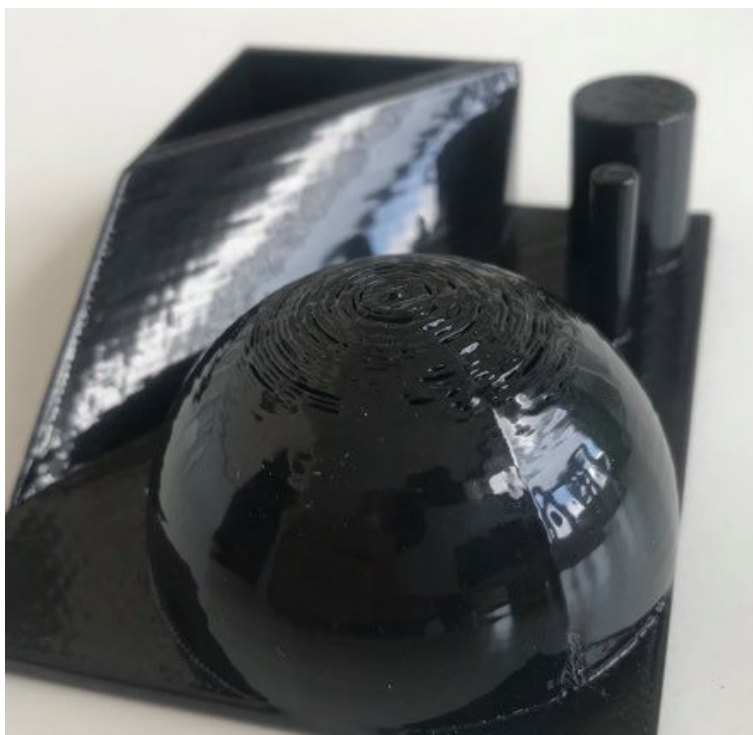
Obrázek 30 - ideálně opraný vzorek ASA vytisknutý na Stratasys F370
