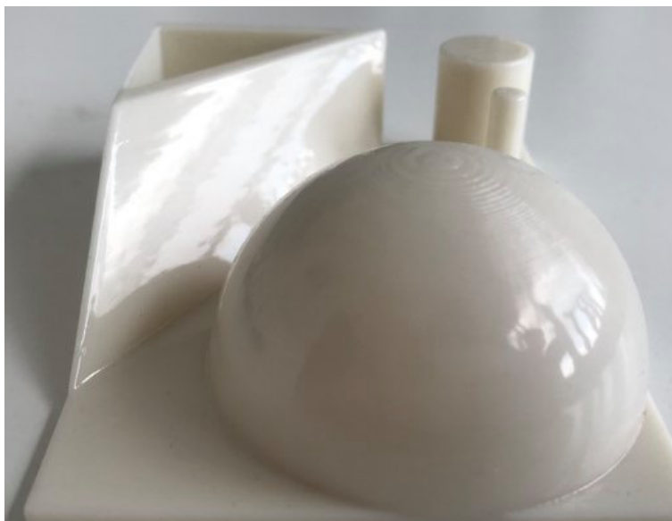
Obrázek 29 - Ideálně opraný vzorek ASA vytisknutý na Prusa MK3S
