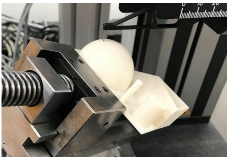
Obrázek 24 - měření drsnosti kopule na konturografu na zařízení Marsurf LD 120
