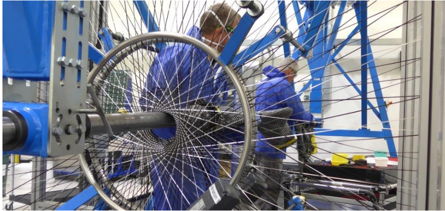
Obrázek 12 - Výroba vrtulového listu oplétáním ve firmě Dowty [15]
