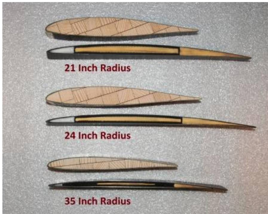
Obrázek 7 - Porovnání celokompozitních listů s dřevěnými listy s kompozitním potahem [9]
