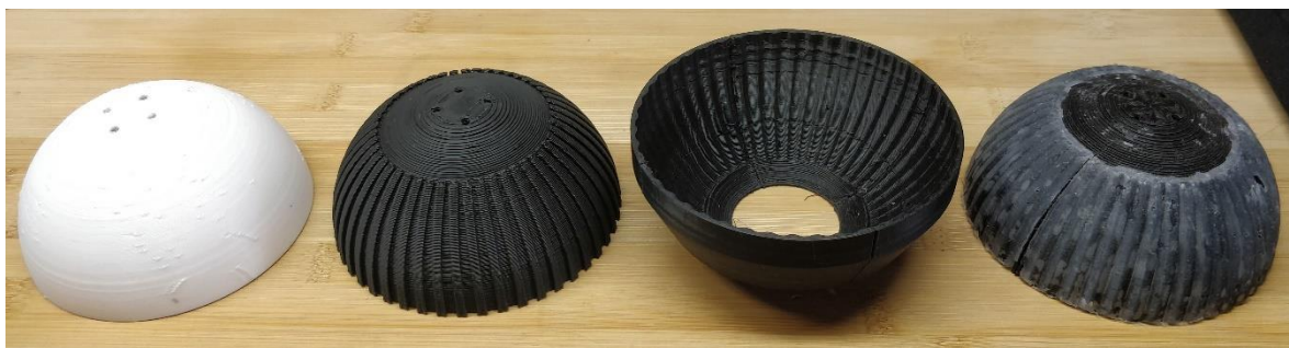
Obrázek 64: Vývoj kola - vnější pohled
