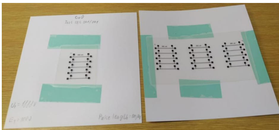
Obrázek 64: Struktury z mědi (inkoust Metalon® ICI-002HV) po několikanásobném žitání
