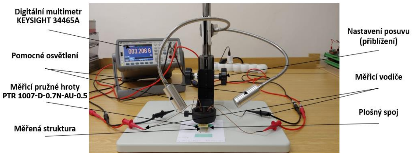
Obrázek 45: Kompletní měřicí sada pro měření odporu natištěných struktur
