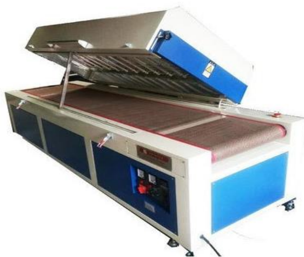
Obrázek 6: Zařízení pro IR vytvrzování v pásové výrobě. Převzato z [4].
