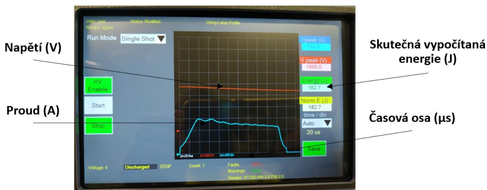
Obrázek 41: Dotykový displej přístroje X-1100. Graf průběhu a hodnoty procesu žíhání.
