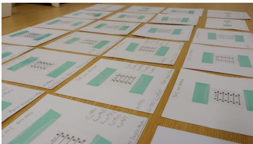
Obrázek 52: Natištěné, žíhané a změřené sady struktur ze stříbra
