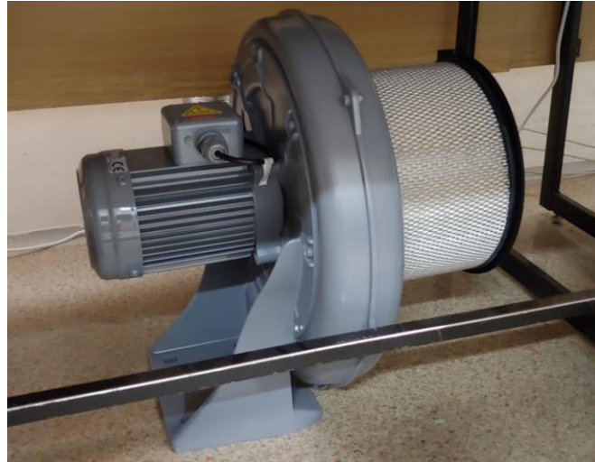
Obrázek 31: Vzduchové chlazení typ TB100-1. Objem vzduchu 18 \text{ m}^3/\text{min}
