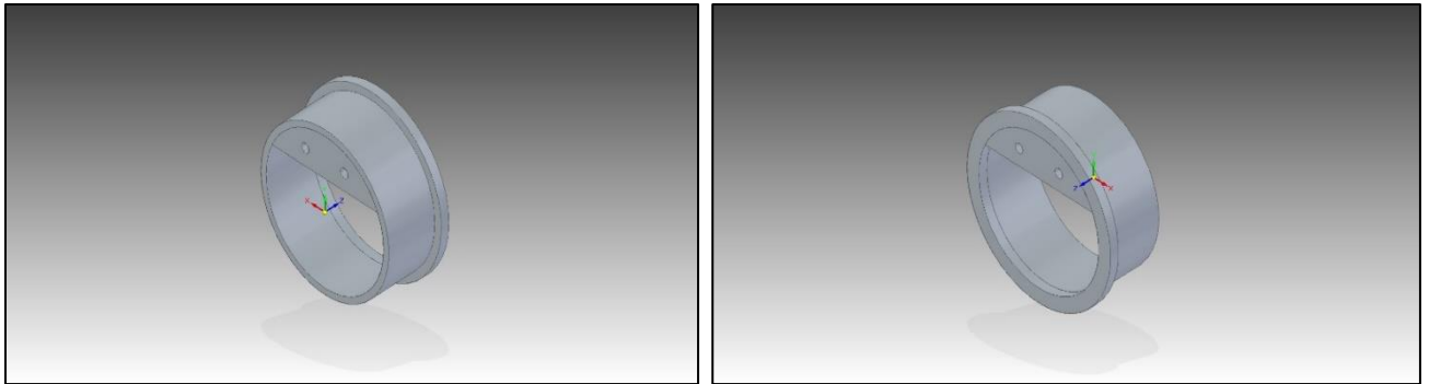
Obrázek 42: Návrh držáku plošného spoje vytvořený v Solid Edge ST8
