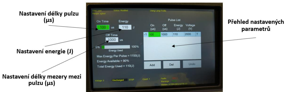
Obrázek 40: Dotykový displej přístroje X-1100. Nastavení délky a energie vyzářeného pulzu.
