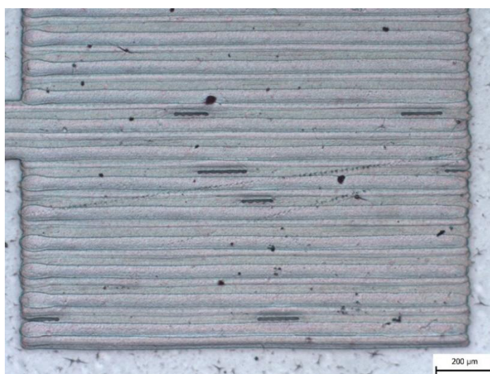
Obrázek 67: Snímek z optického mikroskopu, struktura natisknutá inkoustem Metalon® ICI-002HV po násobném žihání
