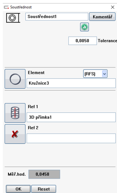
Obr. 4.11 Zadání charakteristiky (soustřednost)
