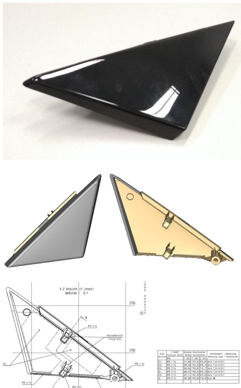
Obr. 3.8 Část karoserie automobilu s výkresem
