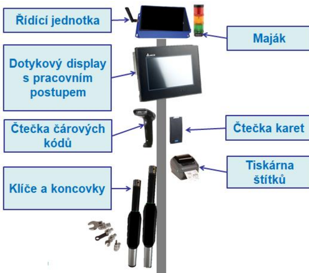
Obrázek 74 - Schéma a popis klíčových komponent utahovací stanice
