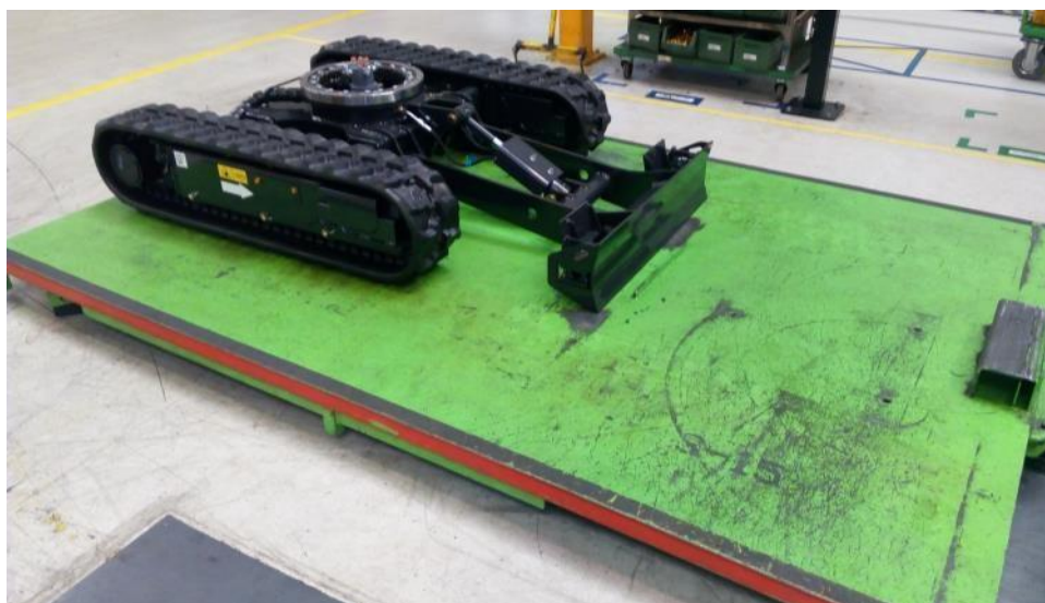
Obrázek 39 - Detail platformy pohyblivé montážní linky [44]
