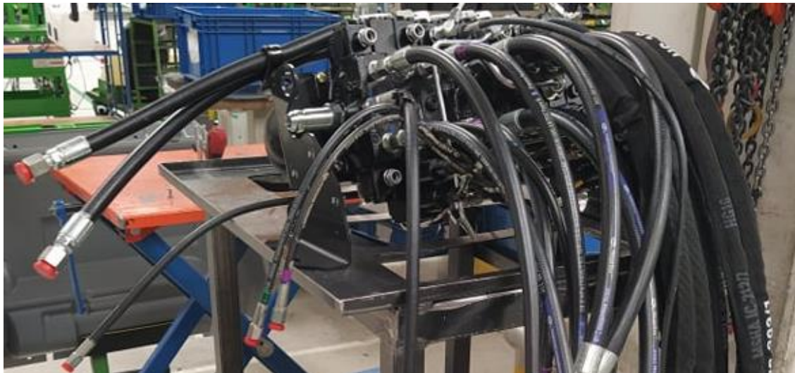
Obrázek 37 - Zkompletovaná sestava hydraulického rozvaděče [44]
