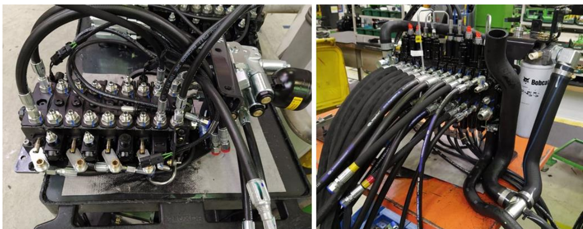
Obrázek 44 - Porovnání hotové sestavy hydraulického rozvaděče pro modely o hmotnosti 1 až 2 tuny (vlevo) a pro rypadla s hmotností 4 až 6 tun (vpravo)
