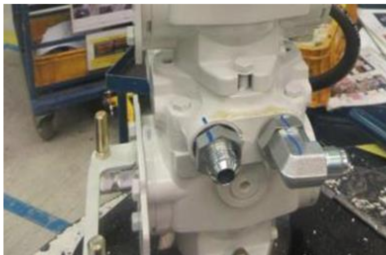
Obrázek 36 - Označený šroubový spoj na hydraulické pumpě nakladače Bobcat
