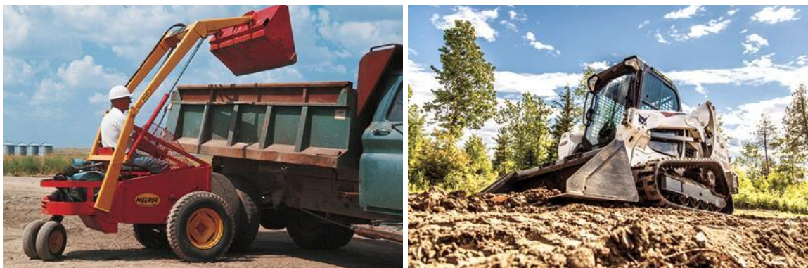
Obrázek 1 - Porovnání nakladače M200 (vlevo) a současného modelu pásového nakladače (vpravo) [1]
