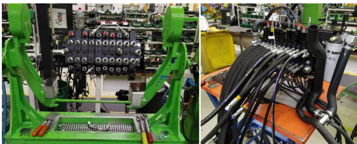
Obrázek 47 - Montážní přípravek pro stroje o hmotnosti 1-3 tuny (vlevo) a pro stroje o hmotnosti 3 – 6 tun (vpravo)
