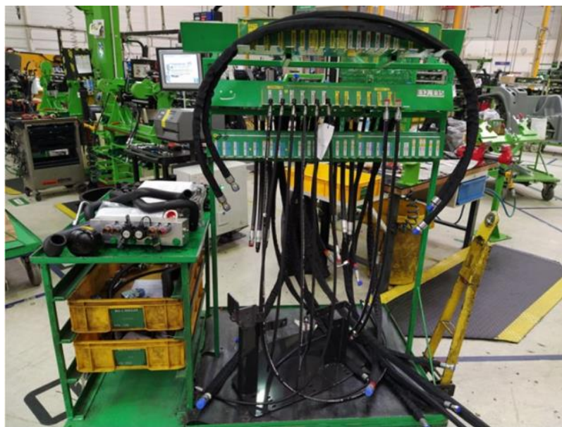
Obrázek 46 - Vozík s díly pro montáž sestavy rozvaděče stroje E50 /
