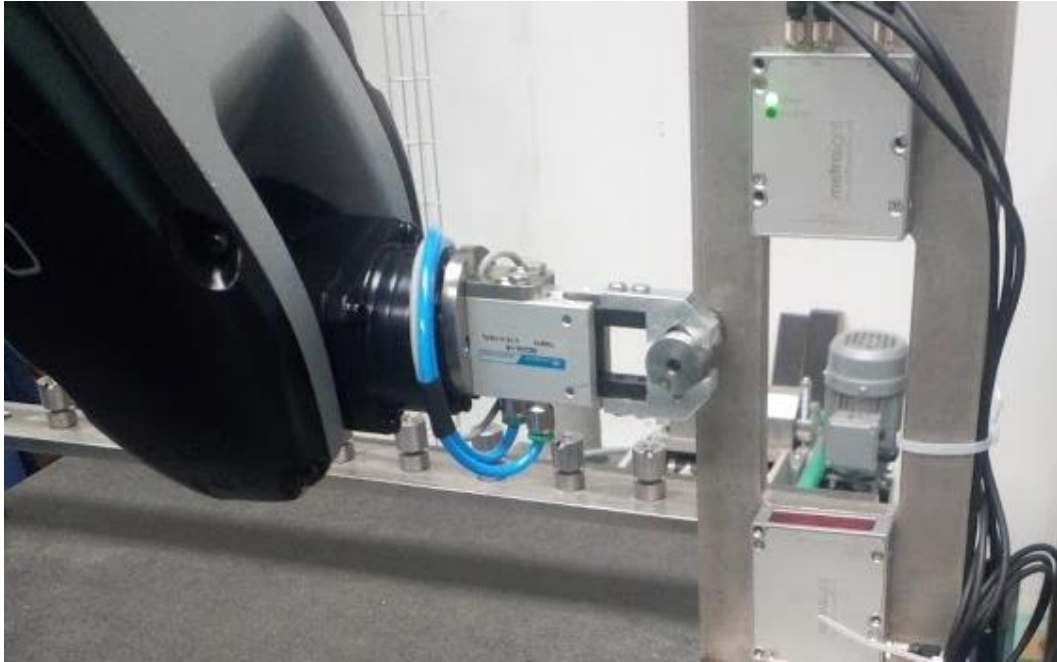
Obrázek 37 Uchopovací sestava pro Racer 5
