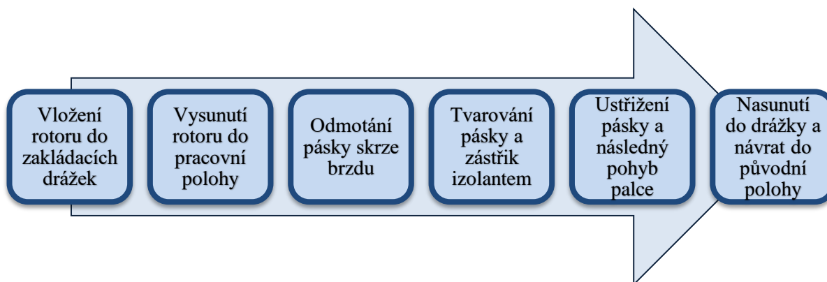
Obrázek 46 - Postup operací pro přípravek s tlačným palcem
