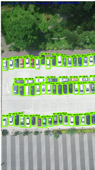
Obr. 3.4: Detekcia objektov na prvom obrázku počet detekovaných objektov: 58
