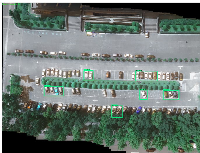
Obr. 3.27: Ukážka neúspešnej detekcie na ortofotomape vygenerovanej zo série snímok pochádzajúcich z tréningových dát.
