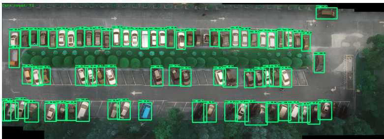
Obr. 3.28: Ukážka úspešnej detekcie na ortofotomape vygenerovanej zo série snímok pochádzajúcich z tréningových dát.
