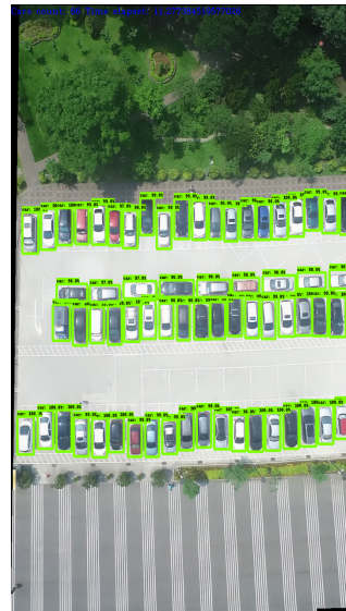
Obr. 3.6: Detekcia objektov na spojení oboch obrázkov počet detekovaných objektov: 66.
