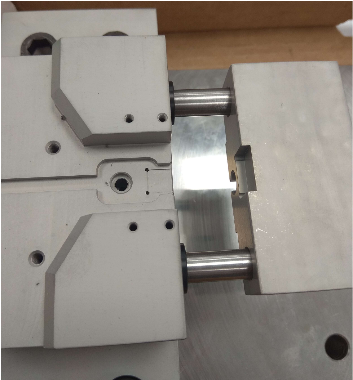
Obrázek 63: Finální přípravek po nitridaci.
