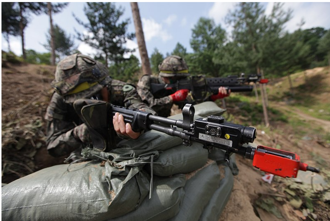
Obrázek 17: Vysílací část systému MILES při použití Jihokorejskou armádou. (Červená koncovka není součástí systému, jedná se pouze o adaptér pro střelbu slepými náboji) (15)
