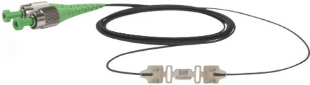
Obrázek 20: Ukázka vnitřního měřítka optického tenzometru (13)
