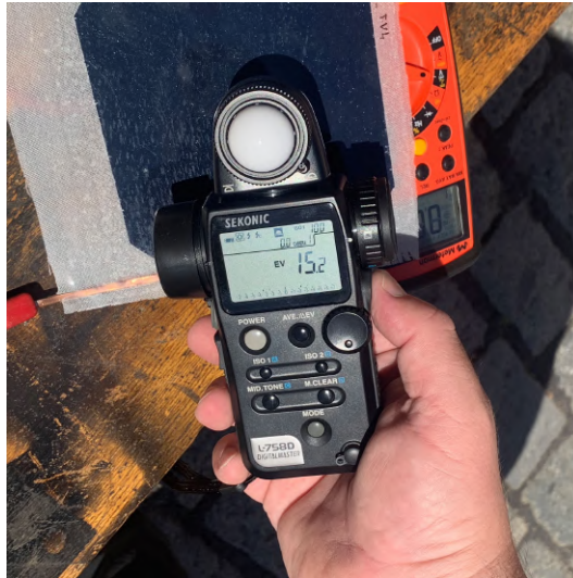
Obr. 114: Měření intenzity osvětlení expozimetrem
