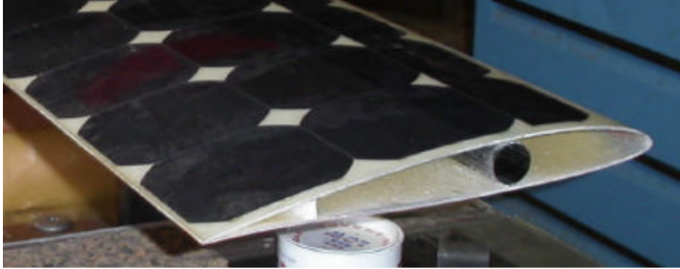
Obr. 40: FV články na křídle letounu SoLong [11]
