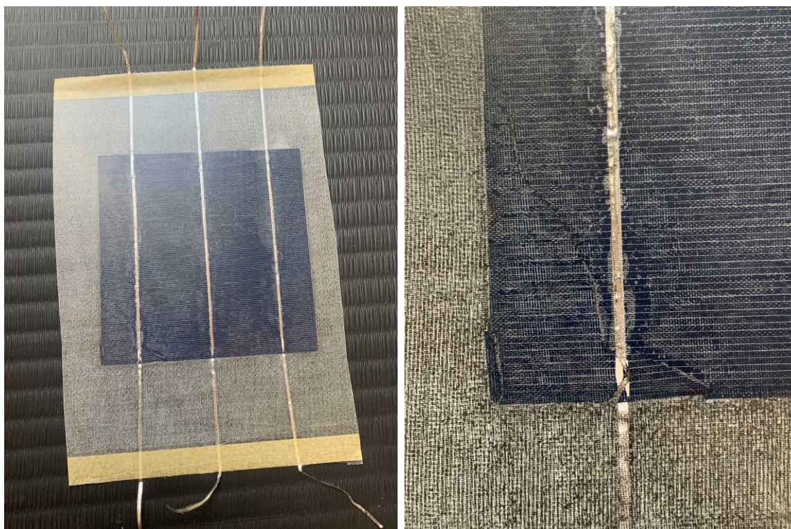
Obr. 61: Výsledný povrch vzorku FV2 s odlomeným rohem
