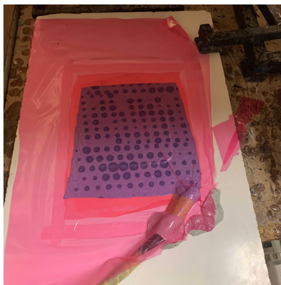
Obr. 54: Vzorek ABS při vytvrzování v peci
