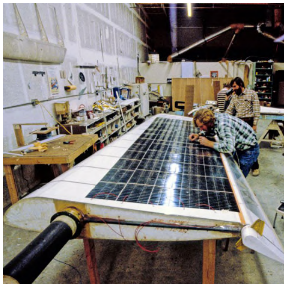
Obr. 4: FV články na křídle Solar Challenger [5]
