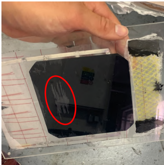
Obr. 80: Vzorek FV 3 po vytvrzení - pohled skrz formu
