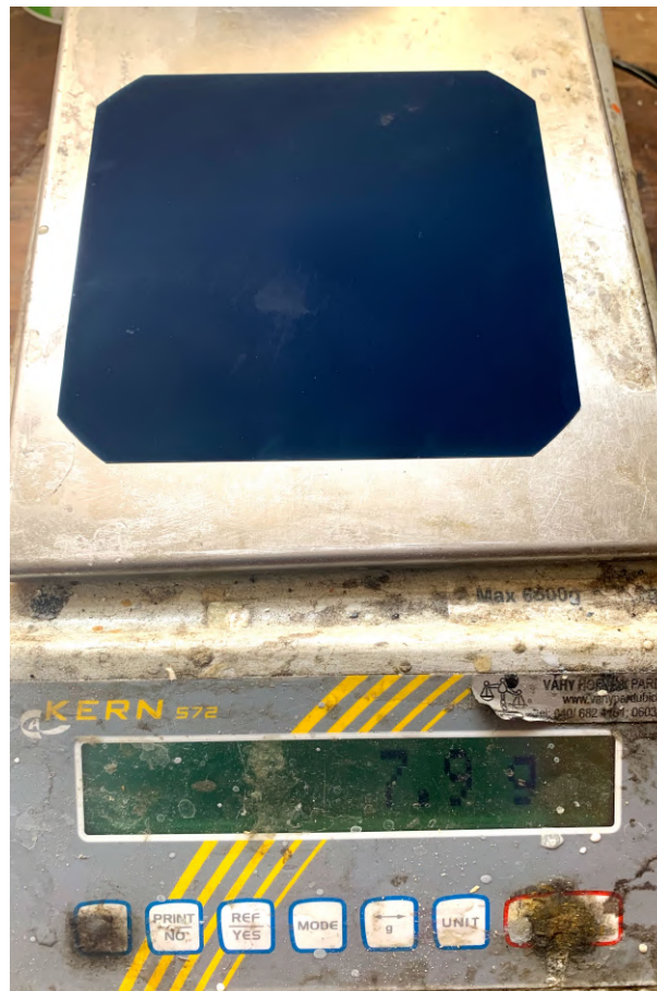
Obr. 101: Hmotnost FV článku SunPower Maxeon
