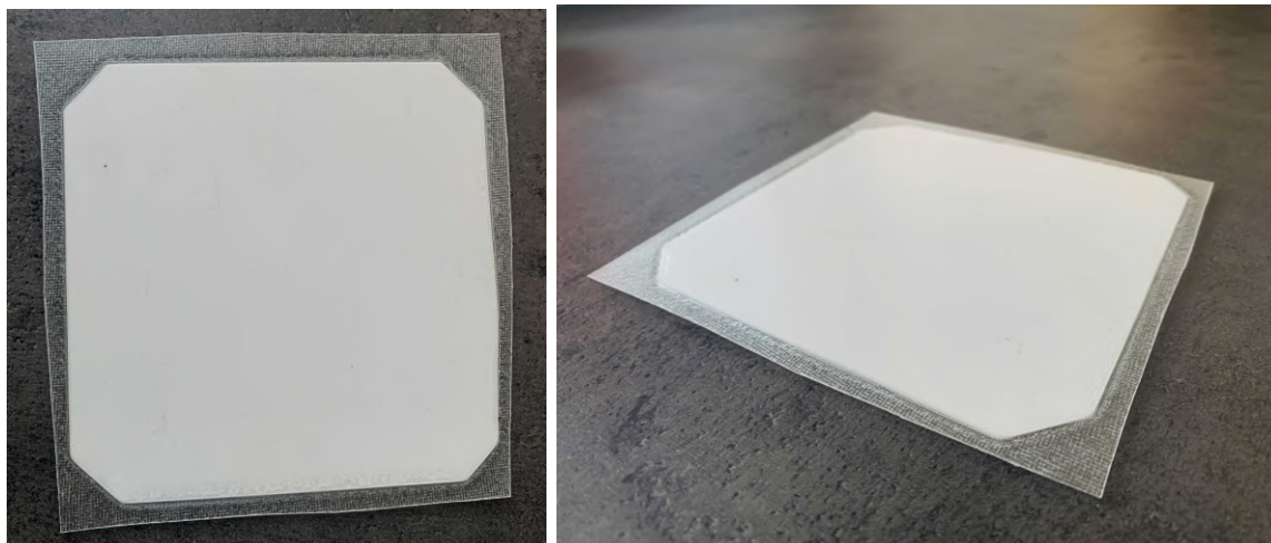
Obr. 55: Výsledný povrch vzorku ABS pomocí kontaktní laminace
