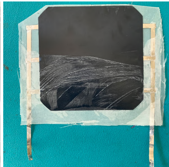
Obr. 81: Vzorek FV 3 po nepodařené separaci
