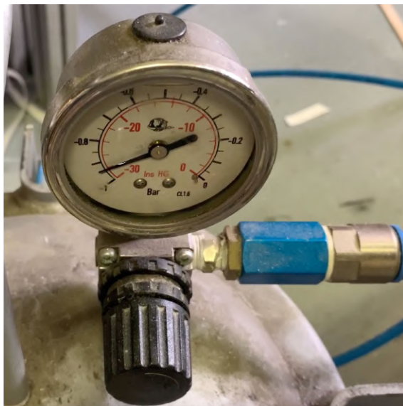
Obr. 86: Obvyklá hodnota podtlaku
