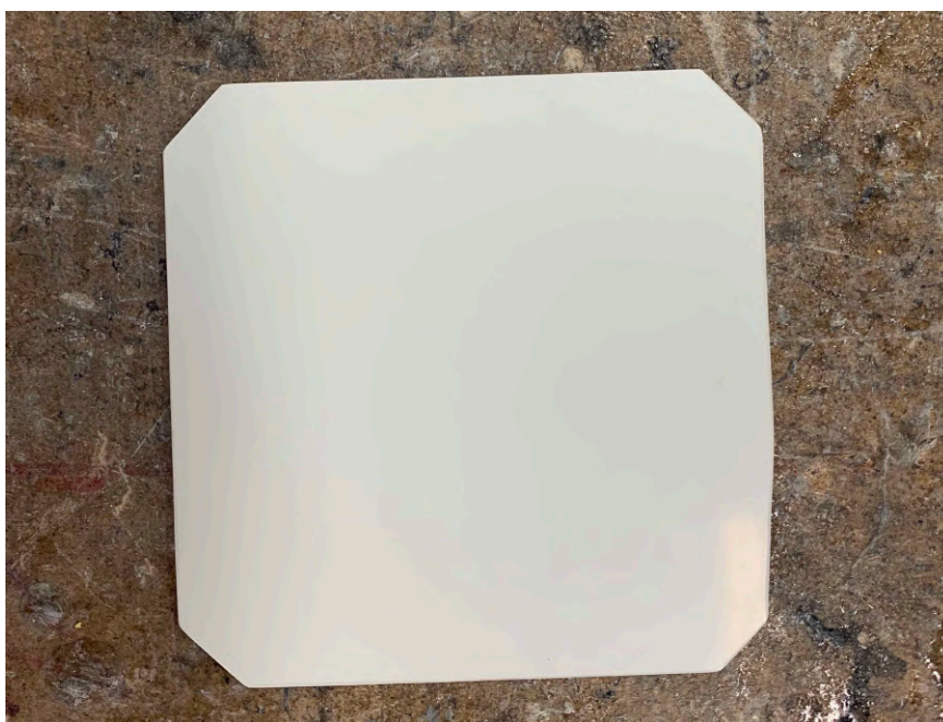
Obr. 51: ABS plastová deska ve tvaru článku SunPower Maxeon
