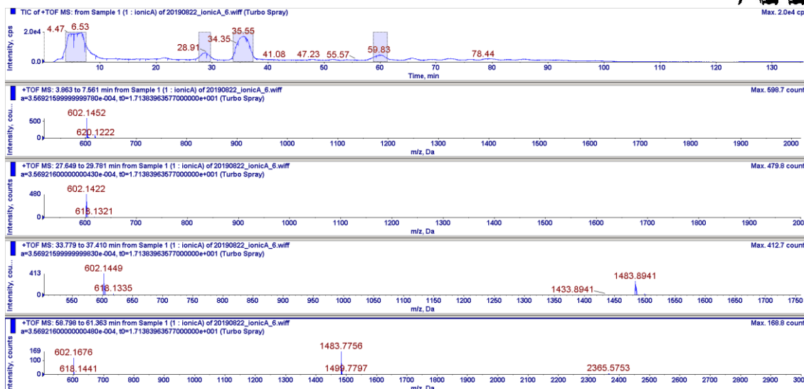
Graf 4.4 První graf zobrazuje průběh signálu během skenování, zbývající grafy zobrazují naměřené hodnoty m/q pro analyty čtyř piků s nejvyšší intenzitou
