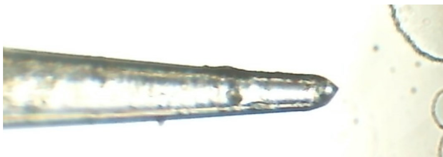
Obr. 4.1 Vizuálně stabilní elektrosprej (kapilára a Taylorův kužel vytvořený roztokem na jejím konci)
