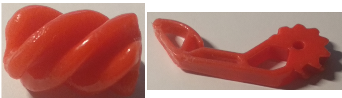
Obrázek 4.14 – Vytisknutý šnek (vlevo) a čelist (vpravo) po aplikování lázně acetonových výparů
