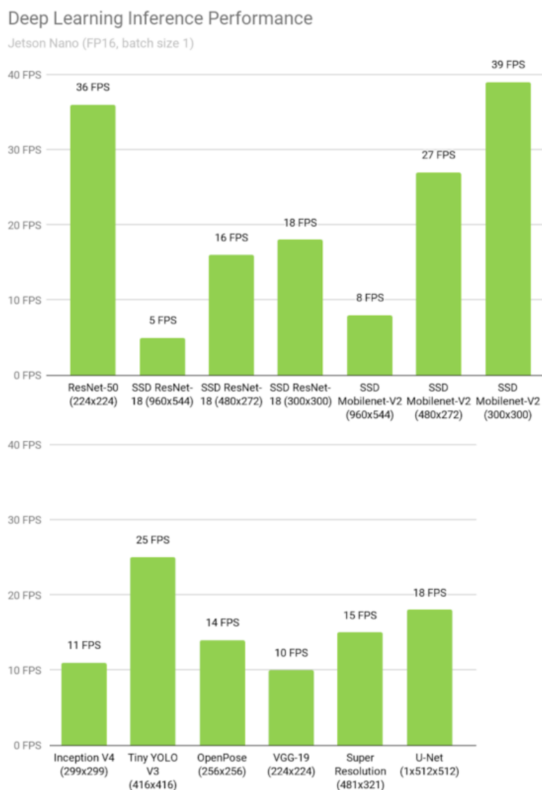
Obrázek 3.6 – Inference ve snímcích za sekundu pro Jetson Nano a ostatní platformy [21]
