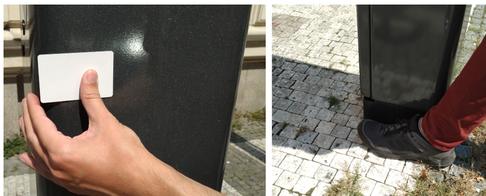
Obrázek 5.1: Měření rozměrů objektu kartou o velikosti kreditky nebo ve stopách
