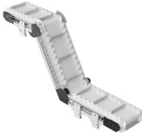
Obrázek 1.3: Dopravní pás se zarážkami [2]
