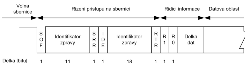
Obrázek 2.6: Začátek datové zprávy rozšířeného formátu podle 2.0B [20]
