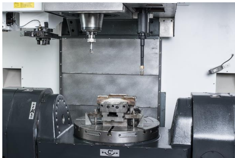
Obr.20 Stroj umožňující technologii navařování elektrickým obloukem [31]
