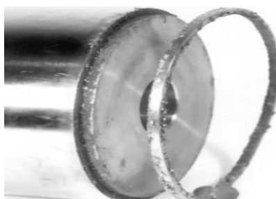
Obr.22 Odebraný materiál v podobě prstence pomocí laseru [34]
