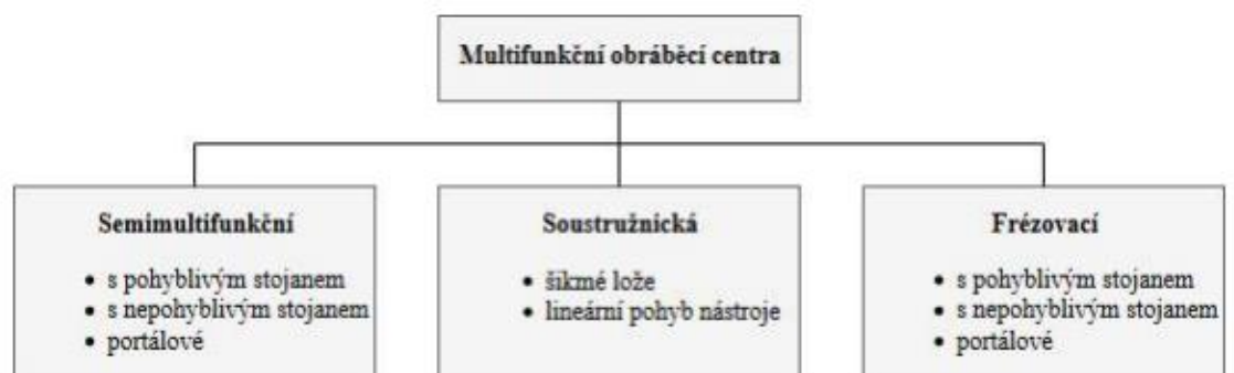
Obr.15 Rozdělení obráběcích center [10]
