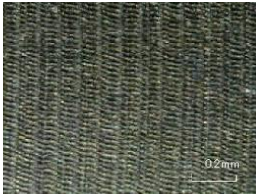
Obr.35 Obrobení ultrazvukovou technologií [43]
