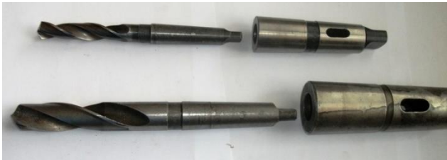
Obrázek 9 - Vrtáky s kuželovou stopkou a redukční vložky [7]
