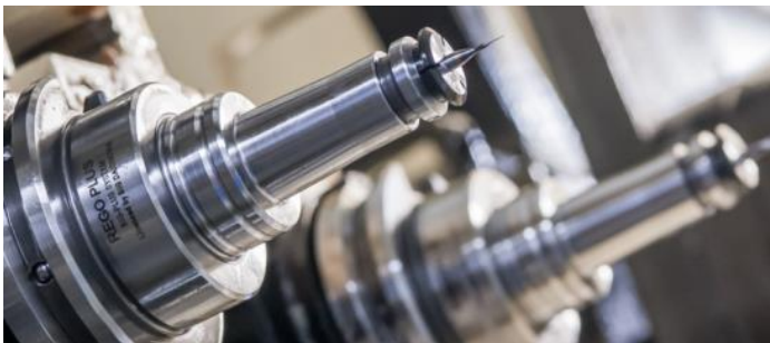
Obrázek 16 – Upnutí mikrovrtáku pomocí hydraulického upínače [14]
