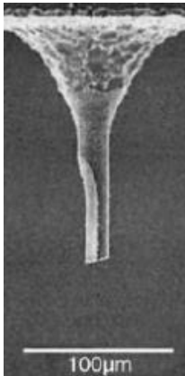
Obrázek 26 - Mikrovrták tvaru D o průměru 17 \mu\text{m} - [10]
