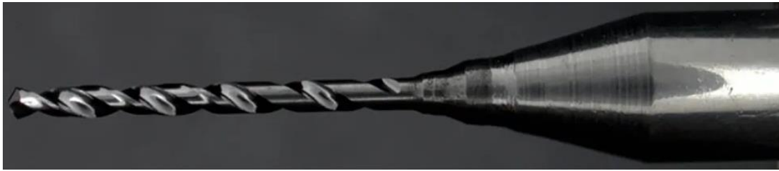
Obrázek 19 - Mikrovrták se dvěma drážkami [13]
