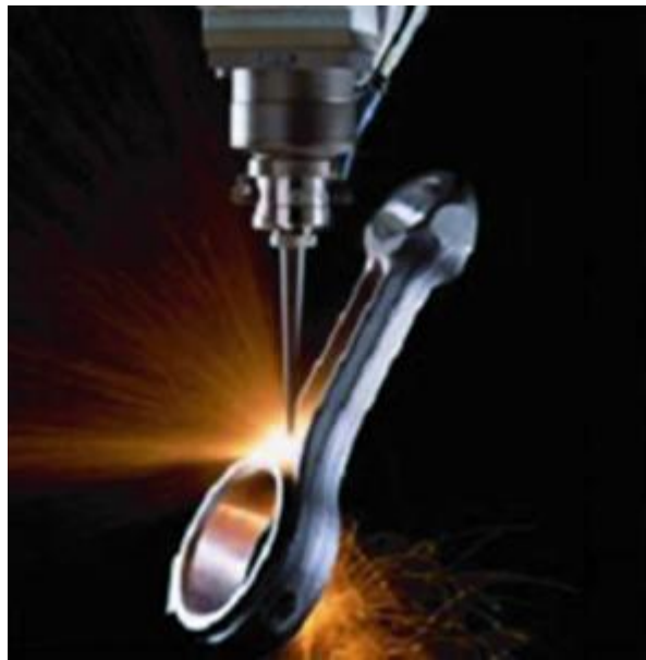
Obrázek 15 Pohled do pracovního prostoru během vrtání laserem [31].
