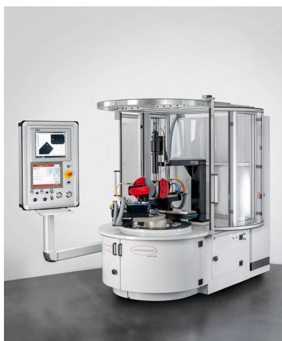
Obr. 17: Orvnávací stroj GAPI-5 CNC od firmy Cleveland Lineartechnik GmbH [30]
