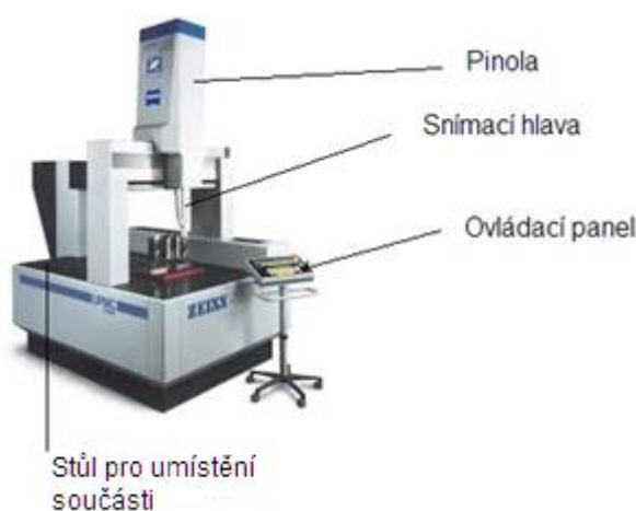
Obr. 1 Portálový souřadnicový měřicí stroj UPMC 850 Carat
