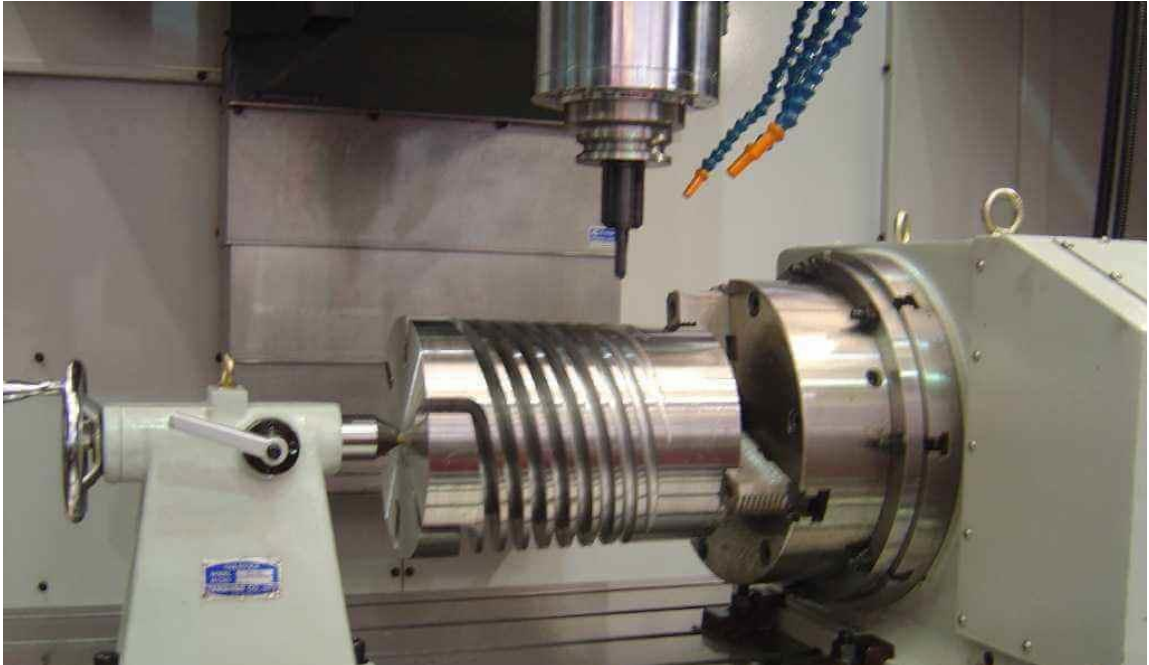
Obr. 6 - Ukázka čtyřosého frézovacího centra [9]
