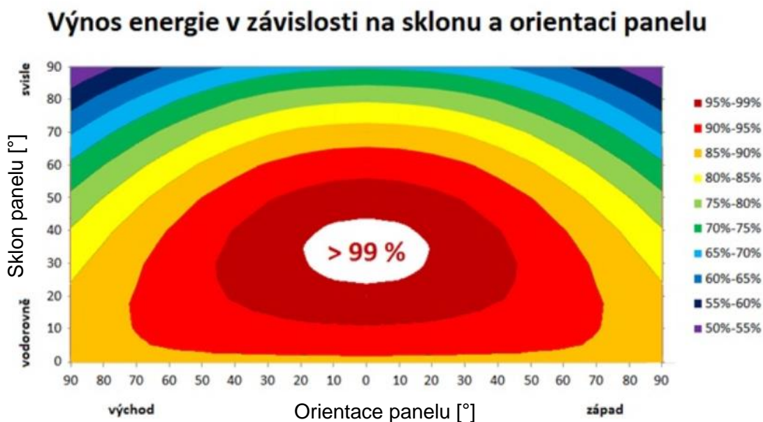
Obrázek 16: Výnos energie panelu v závislosti sklonu a orientace (upraveno) [11]
