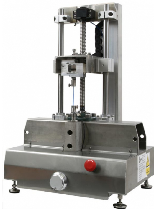
Obrázek 4.13: Trhačka DEFORM 02 - přenosné zkušební deformační zařízení. Převzato z [49].
