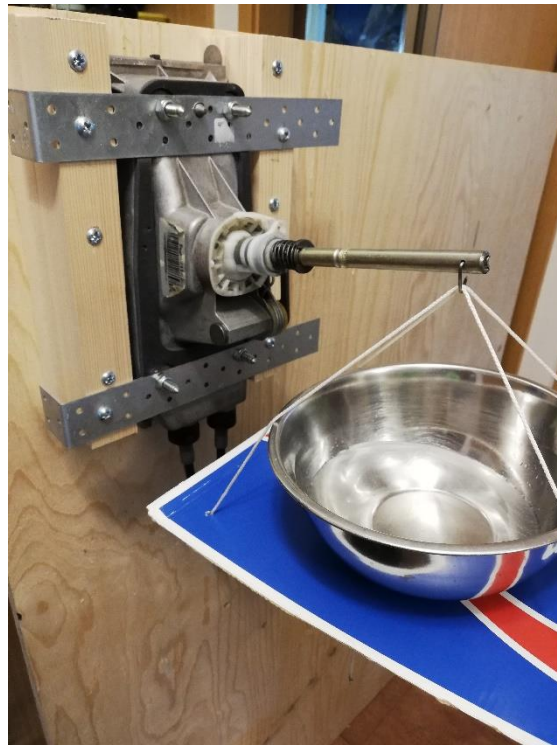
Obrázek 47 - Upevnění tělesa řadící páky + zavěšení závaží
