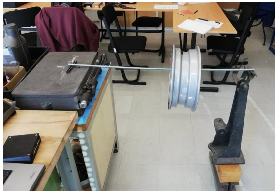
Obrázek 32 - Sestava pro určení polohy těžiště ráfku
