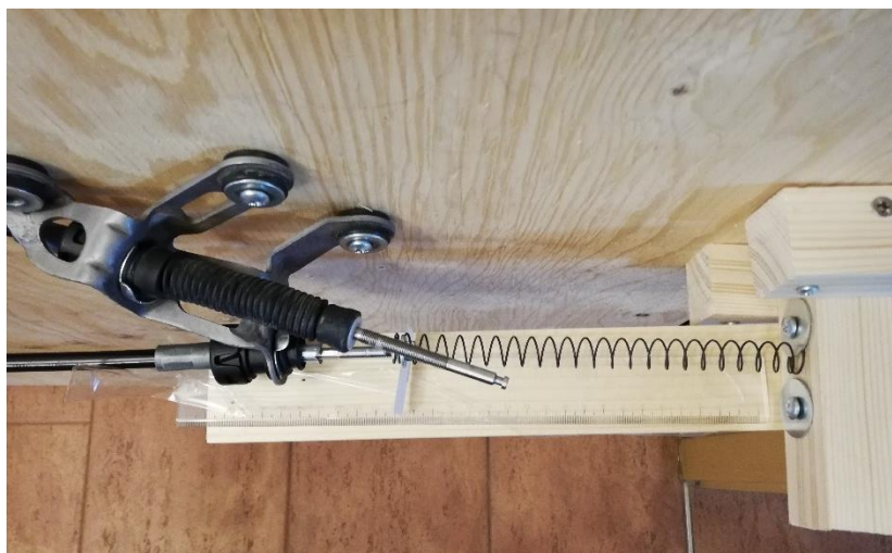
Obrázek 48 - Detail měření prodloužení pružiny
