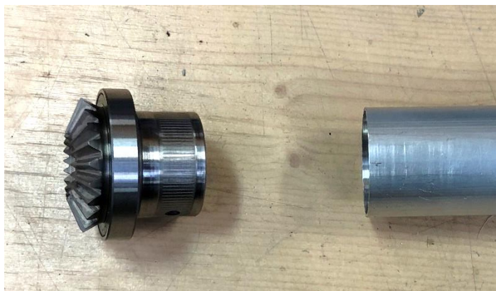
Obr. 39 Volantová tyč s horní částí kuželového soukolí [autor]
