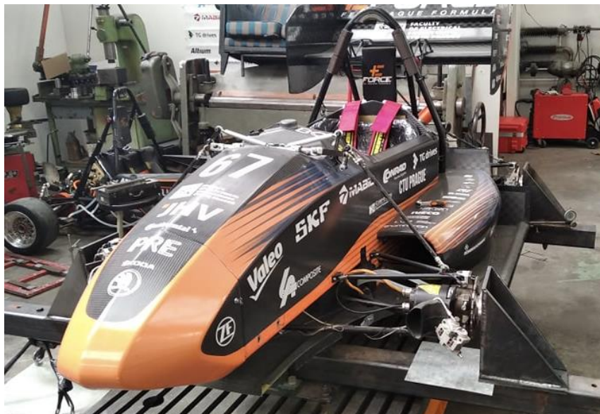
Obr. 43 Přípravek na měření torzní tuhosti monokoku [autor: člen týmu eForce]
