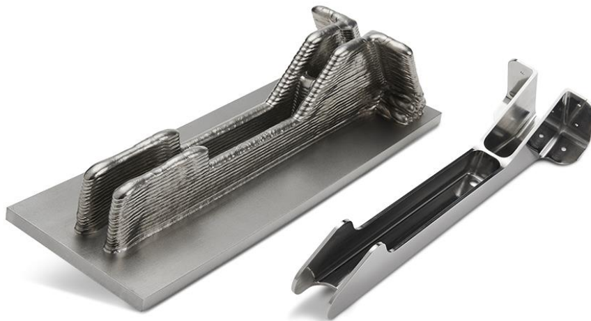
Obr. 21: Rapid plasma deposition – součást Boeingu 787 navařená z Ti drátu [37]
