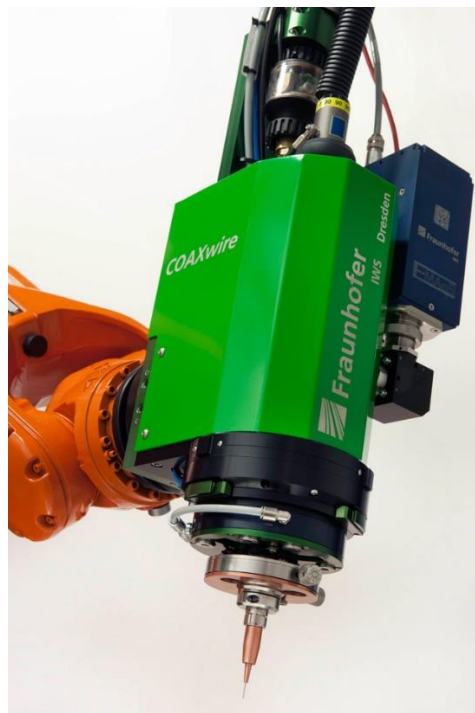
Obr. 34: Fraunhofer IWS, koaxiální hlava COAXwire [55]
