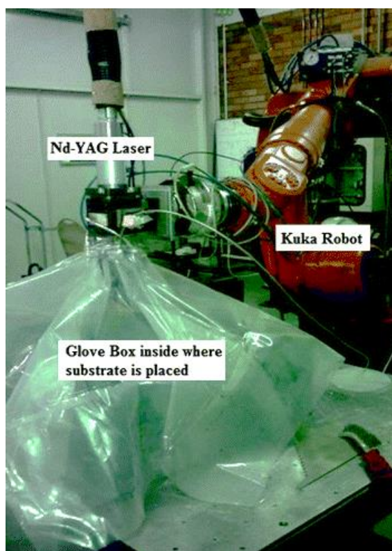
Obr. 47: Uzavřená komora z poddajného materiálu [79]
