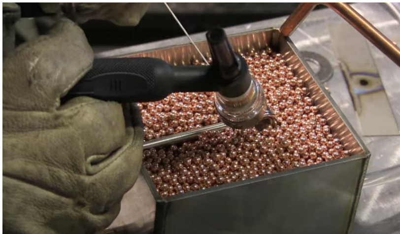
Obr. 46: Otevřená komora pro svařování titanu metodou TIG [78]
