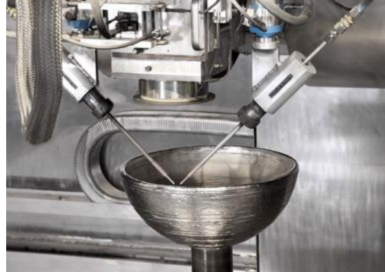
Obr. 7: Navařená součást technologií EBAM [11]
