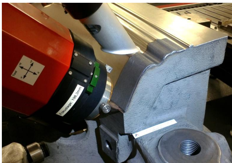
Obr. 42: ALOtec, systém pro navařování z drátu [63]
