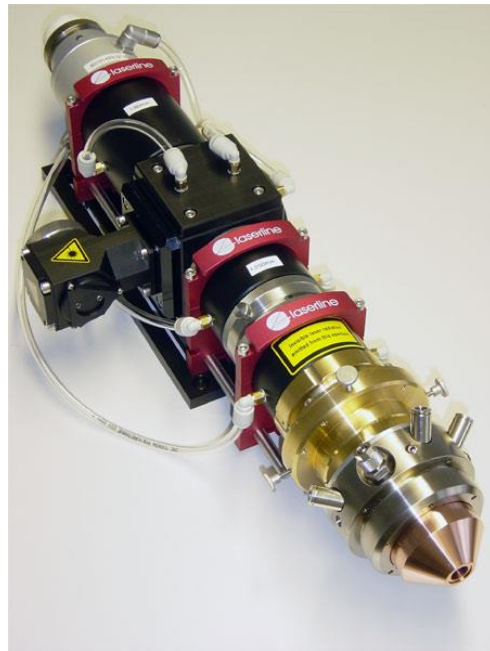
Obr. 30: Fraunhofer IWS, univerzální tryska COAX8 (spolupráce s Laserline) [51]
