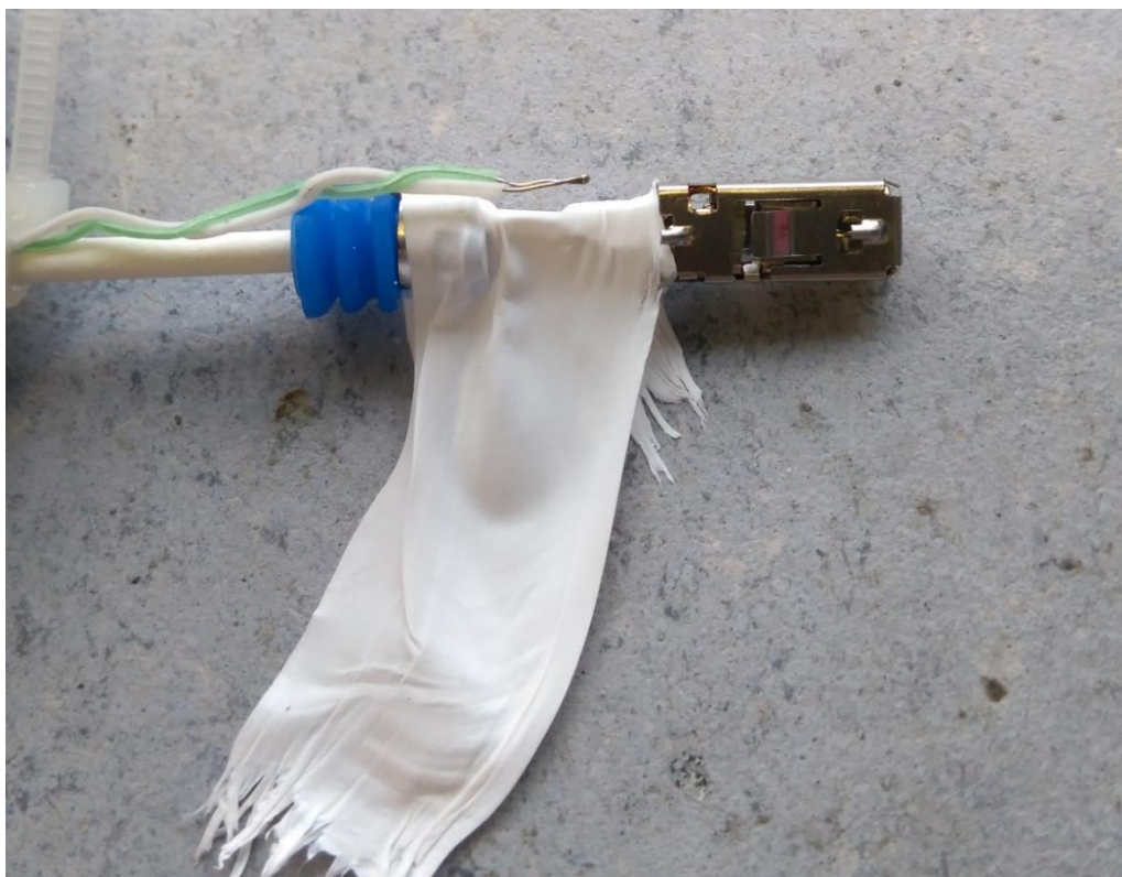
Obrázek 8 Terminál s mezivrstvou a termočlánkem
