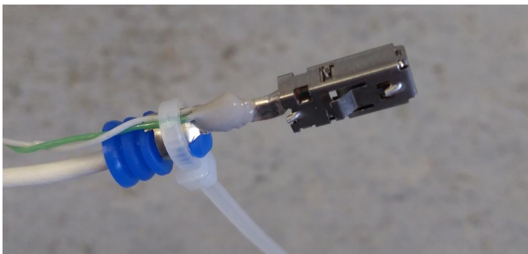
Obrázek 11 Termočlánek připevněný lepidlem
