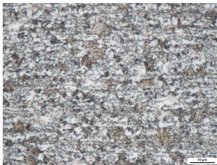
Obr. 21 Metalografické výbrusu při zvětšení 1000x z materiálu DP1000 v: A, podélném směru; B, příčném směru
