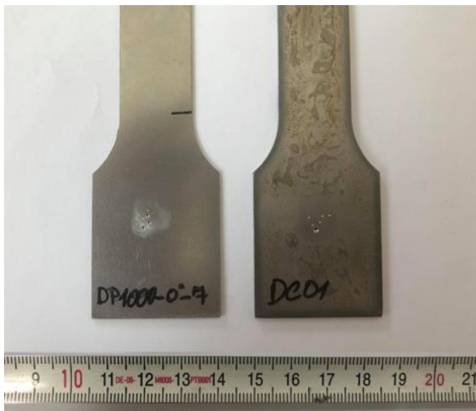
Obr. 11 Vybrané vzorky s provedenými zkouškami tvrdosti
