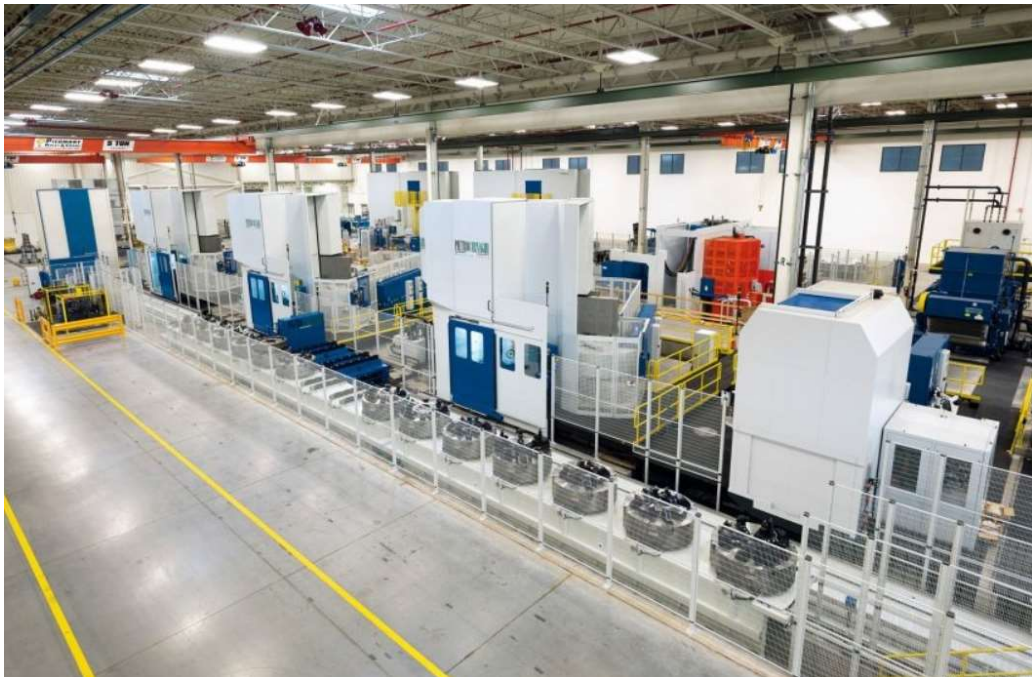
Obr. 17 PIETRO CARNAGHI – konfigurace 16 palet a 4 stroje [33]
