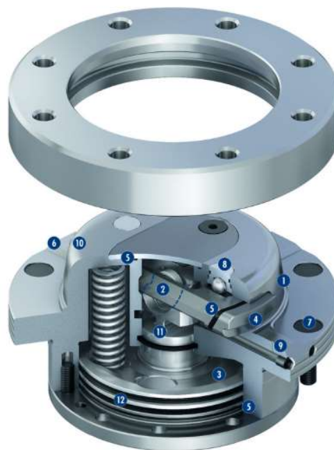
Obr. 23 Průřezový diagram upínacího systému NSA plus od f. SCHUNK (1 = vysoce přesné středění krátkého kuželu, 2 = patentový systém dvojitého zdvihu, 3 = funkce turbo, 4 = velké povrchy pro přenos sil, 5 = kompletně uzavřený systém, 6 = podpora pro vyšší tuhost, 7 = krytky šroubů, 8 = zvedání při otevírání modulů, 9 = monitorování kontaktu, 10 = vstupní poloměry modulů, 11 = flexibilní píst, 12 = pneumatický systém) [41]
