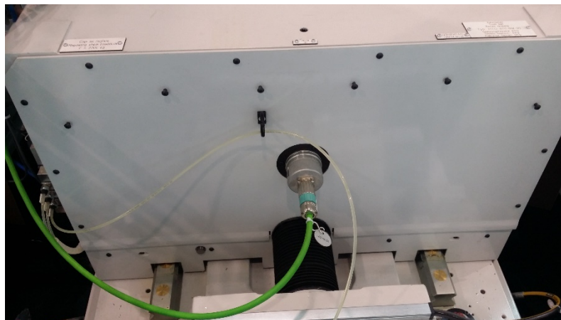
Obr. 32: Zakrytovaný řemenový převod
