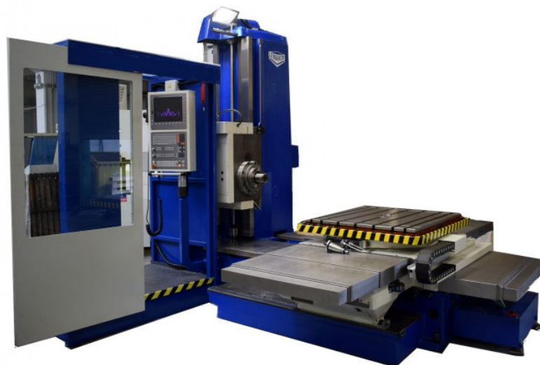
Obr. 10: Bezpečnostní kabina u horizontální vyvrtávačky WH 10 CNC [17]
