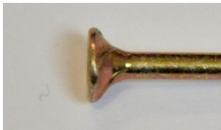
Obrázek 3: Drážkování pod hlavou, Foto autor
