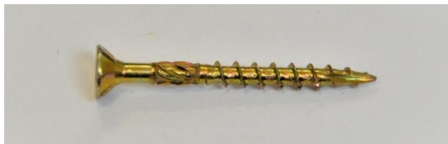
Obrázek 1: Konstrukční vrut s částečným závitem a frézováním, Foto autor
