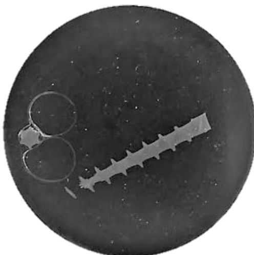
Obrázek 13: Metalografický výbrus – vrut KLIMAS v příčném a podélném řezu
