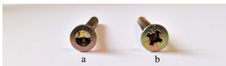
Obrázek 4: Drážky vrtů a) torx, b) křížek, Foto autor
