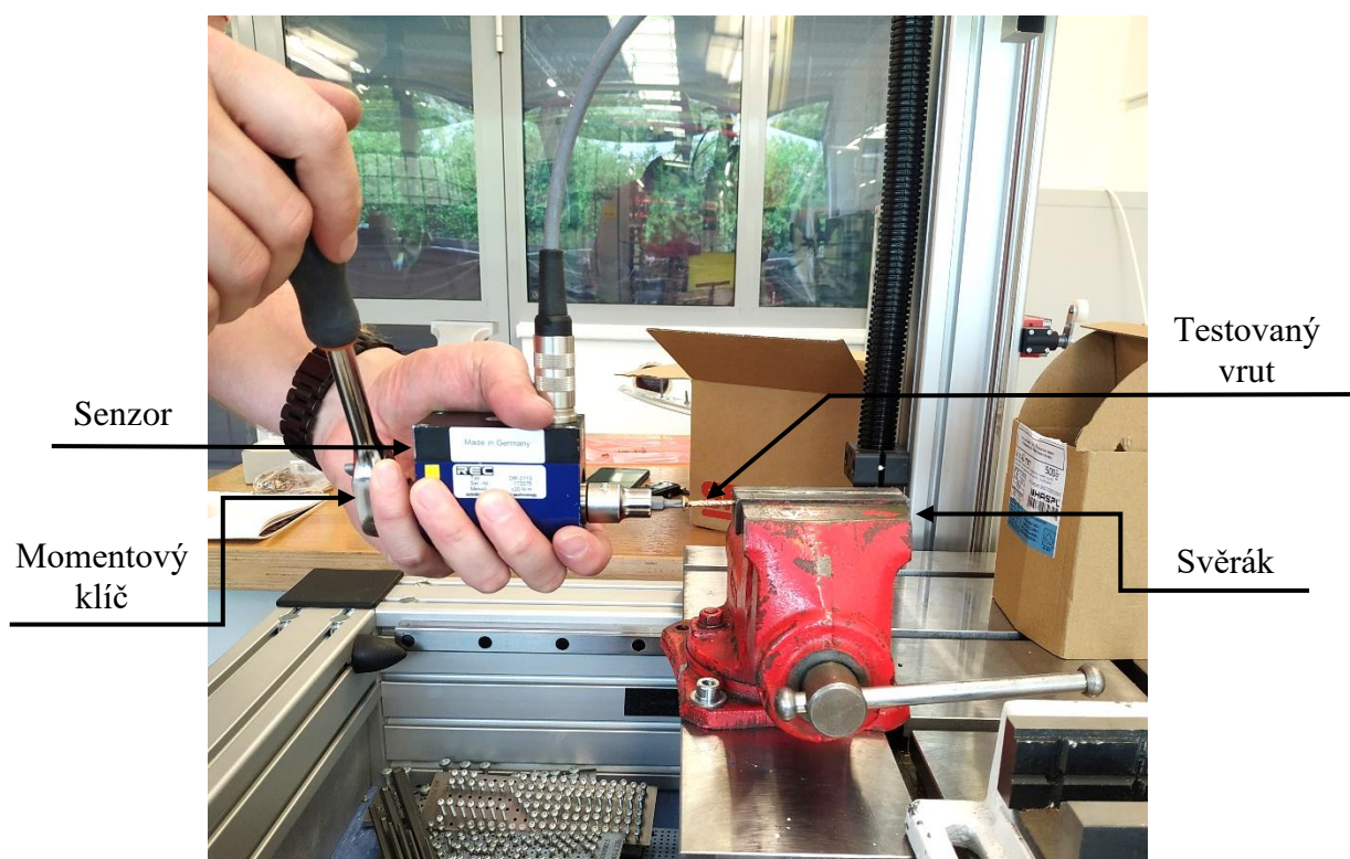
Obrázek 18: Schéma měření prosté zkoušky krutem vrutu
