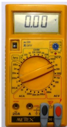
Obr. 1.11 Zapojení měřicích hrotů a nastavení rozsahu měřicího přístroje: a) pro měření napětí, b) pro měření proudu 21
