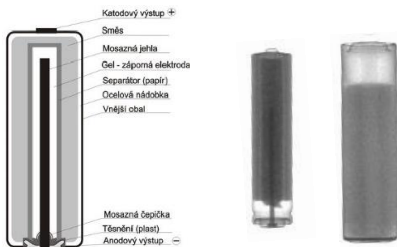
Obr. 2.3 Řez alkalickou baterií a její rtg snímky 27
