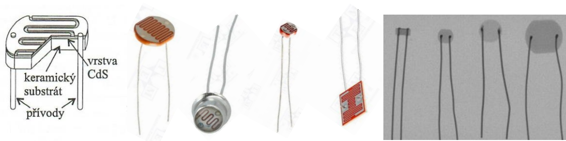
Obr. 4.17 Některá výrobní provedení fotorezistorů a rtg snímek 67
