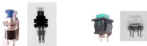
Obr. 3.3 Některá výrobní provedení tlačítkových spínačů a rtg snímky. 43
