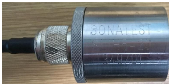
Obr. 52: Imerzní sonda SONATEST SLIH5 – 20
