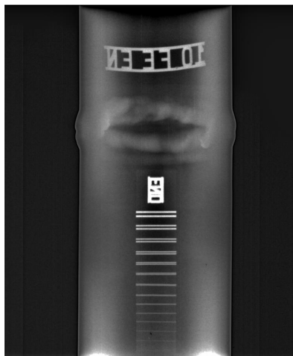
Obr. 37: Snímek svaru technikou eliptického prozařování
