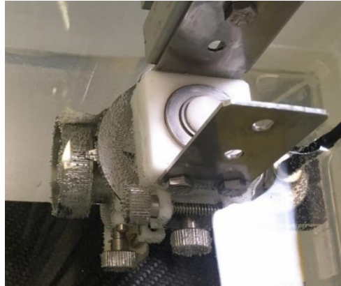
Obr. 57: Vzduchové bubliny na sondě a vzorku
