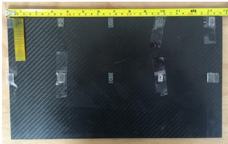
Obr. 47: Vzorek s číselným označením a dvojdřátkovou měrkou
