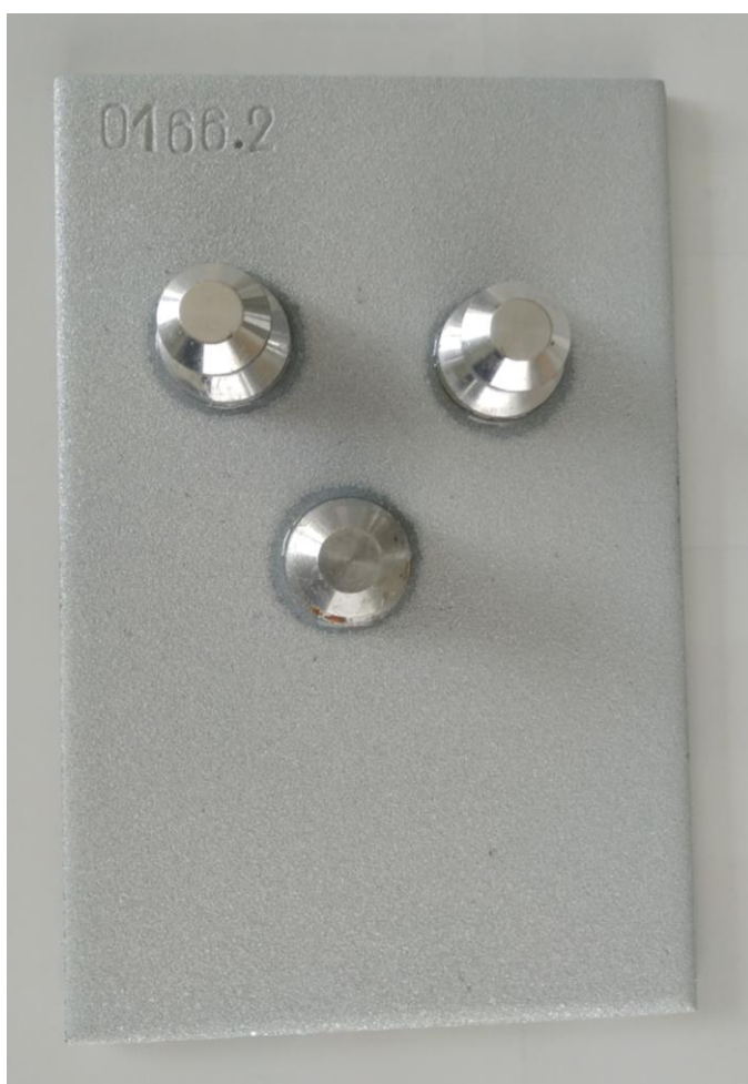
Obrázek 23 - Ilustrativní ukázka rozmístění panenek ke zkušebnímu vzorku
