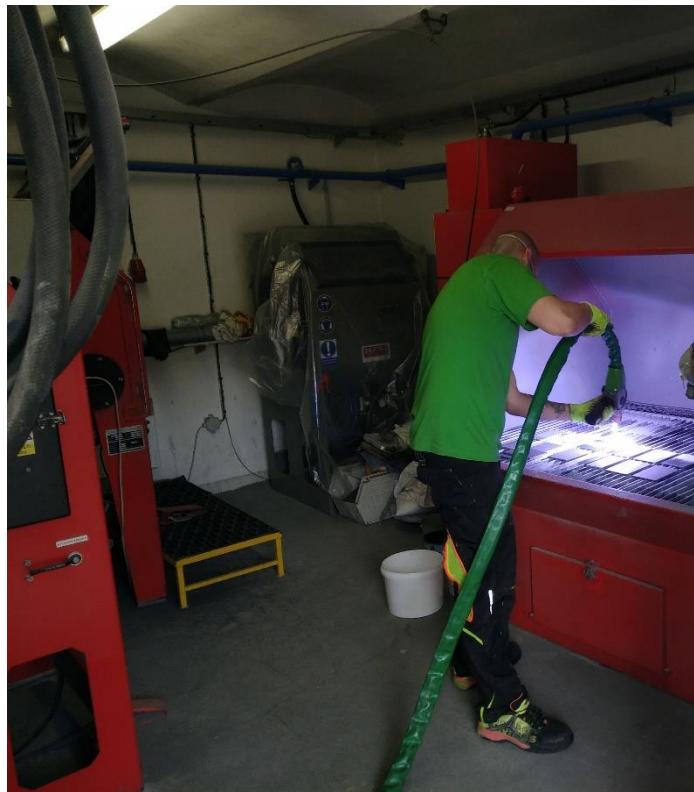
Obrázek 21 - Nástřik povlaku ZnAl 85/15 ve firmě S.A.F. Praha
