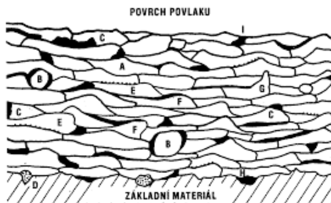
Obrázek 12 – Struktura povrchu: A - deformovaná částice přídavného materiálu; B - nedeformovaná částice přídavného materiálu; C - pórovitost v povlaku žárového nástřiku; D - zakotvená částice tryskacího média; E – prachová frakce materiálu povlaku; F - tvrdá fáze v povlaku žárového nástřiku; G - pórovitost na hranici mezi deformovanými částicemi; H - pórovitost na hranici povlak – podložka; I - otevřená pórovitost v povlaku; https://www.plotybohumin.cz/povrchove-upravy-kovu/
