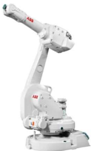
Obr. 14 Angulární robot ABB IRB 1600 [26]
