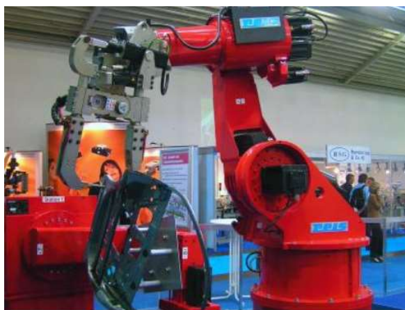
Obr. 24 Robot s technologickou hlavicí pro bodové svařování [33]
