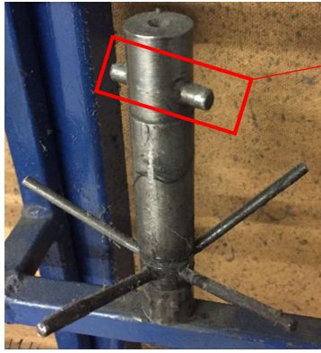
Obr. 36 Tělo jehliček spojující jehličky s vřetenem
