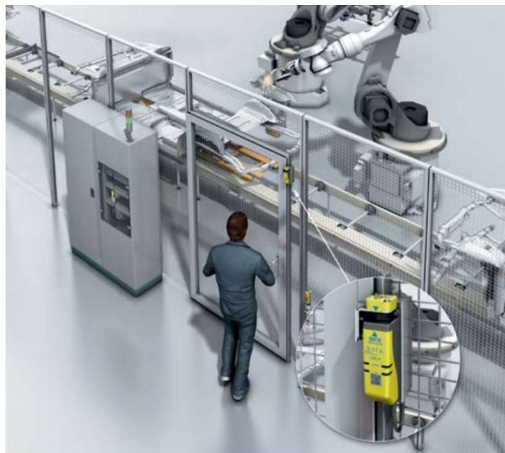
Obr. 30 Oplocené robotické pracoviště s detailem na bezpečnostní dveřní snímač [41]
