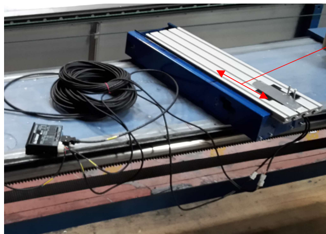
Obr. 70 Řízená lineární osa pro příčný posuv navíjecího oka - zdroj CompoTech
